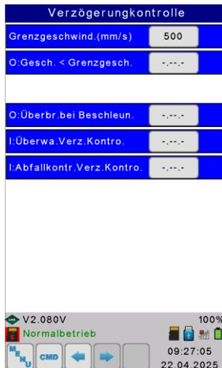
Die Verzögerungskontrollschaltung überwacht die Einfahrgeschwindigkeit in die Endhaltestellen. Dazu ist im oberen und unteren Bereich des Schachtes jeweils ein Verzögerungskontrollpunkt, an dem die Geschwindigkeit unter einem bestimmten Wert liegen muss.
