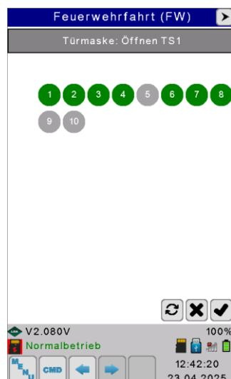
Der Button „“ wählt alle Etagen bzw. nach nochmaligem Drücken keine Etage aus. Änderung der Türmaske einzeln durch Antippen der Etagennummer. Abspeichern der Änderungen mit „“ nicht vergessen.
