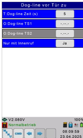
Die Dog-Line Funktion gibt ein optisches / akustisches Signal mit einem Signalwechsel pro Sekunde aus, sobald ein Innenruf ansteht und / oder die Türen dann geschlossen werden sollen. Die Dog-Line Zeit ist die Dauer des Warnsignals für Hunde. Diese Funktion kann nicht mit dem „Warnsignal vor Tür zu“ kombiniert werden.
