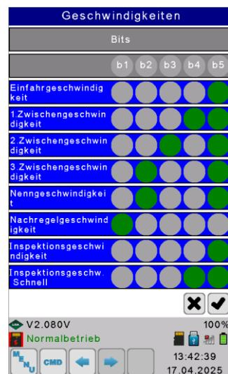
Steuerungsseitig kann zwischen 8 Geschwindigkeiten ausgewählt werden. Diese werden durch 5 codierte Geschwindigkeitssignale (Binär, Gray, ...), dem Umrichter mitgeteilt. Bei linearer Ansteuerung können nur 5 Geschwindigkeiten ausgewählt werden.
