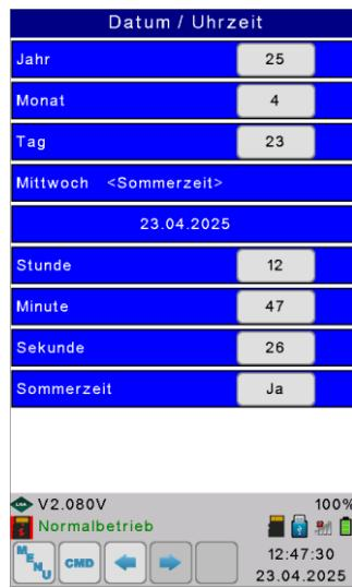
Wird eine Änderung des Datums oder der Uhrzeit gemacht, wird automatisch zum LiSA-Bus die aktuelle Zeit gesendet. Außerdem führt die Steuerung täglich um 0.00 Uhr einen Abgleich der Standanzeigen auf die Systemzeit durch.
