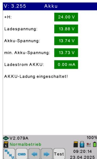
Ist die Akkuladung eingeschaltet, wird dies in der Anzeige notiert. Ebenso die Notwendigkeit einer Ladung und der aktuelle Ladestrom.
