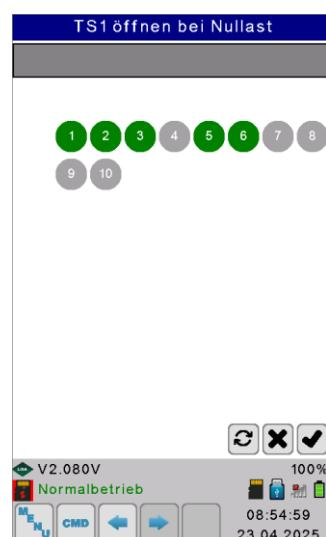
Grün hinterlegte Etagen dürfen bei Etagenrufen nur mit Nulllast angefahren werden. Änderung des Zugangs einzeln durch antippen der Etagennummer, ebenso für TS2. Abspeichern der Änderungen mit „OK“ nicht vergessen.
