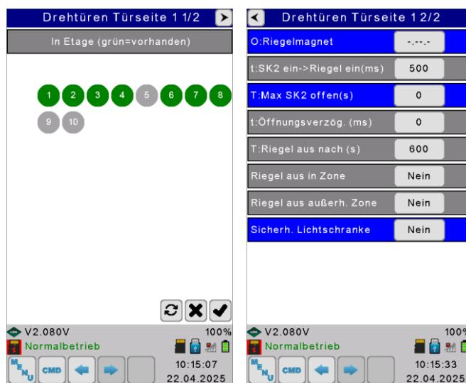
Grün hinterlegte Zugänge sind mit Drehtüre ausgestattet. Zugänge mit grauer Schrift, die nicht grün hinterlegt sind, sind existent, aber ohne Drehtüren. Rot markierte Zugänge sind in den Zugangsmasken nicht aktiviert.
