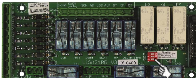
Abbildung 14: Relaisboard mit DIL-Schalter zur Prüfung
